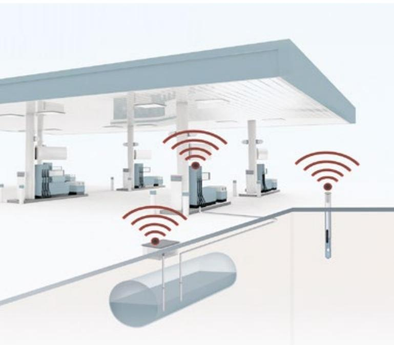
Grafisches Beispiel für die Überwachung und Leckage-Erkennung an einer Tankstelle.
