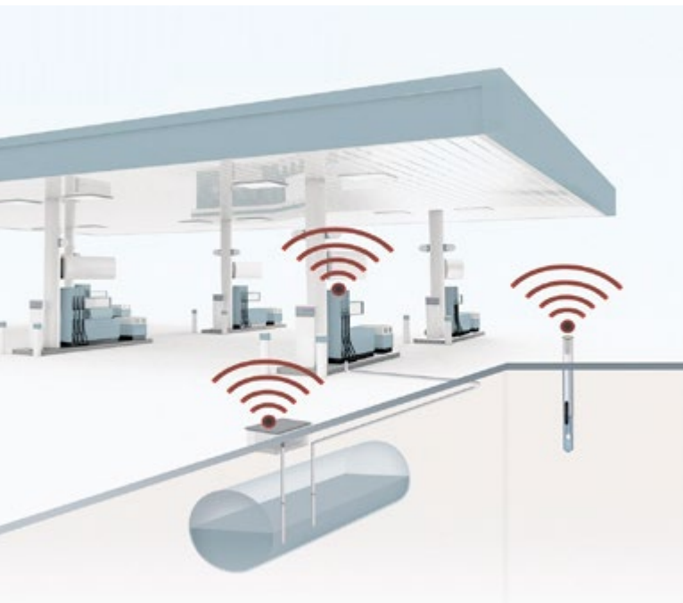
Grafisches Beispiel für die Überwachung und Leckage-Erkennung an einer Tankstelle.
